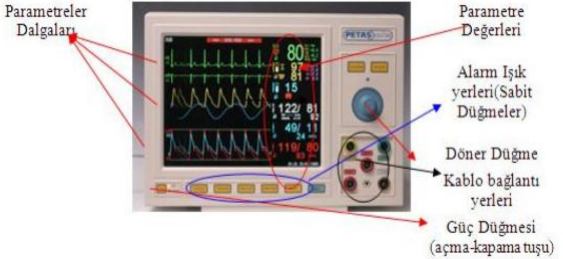
Fotoğraf 13 : Ön panel düğmeleri ve parametreler
